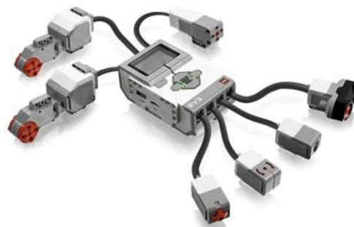
SERWOMOTORY I CZUJNIKI W ZESTAWIE LEGO MINDSTORMS EV3 W WERSJI EDUKACYJNEJ
